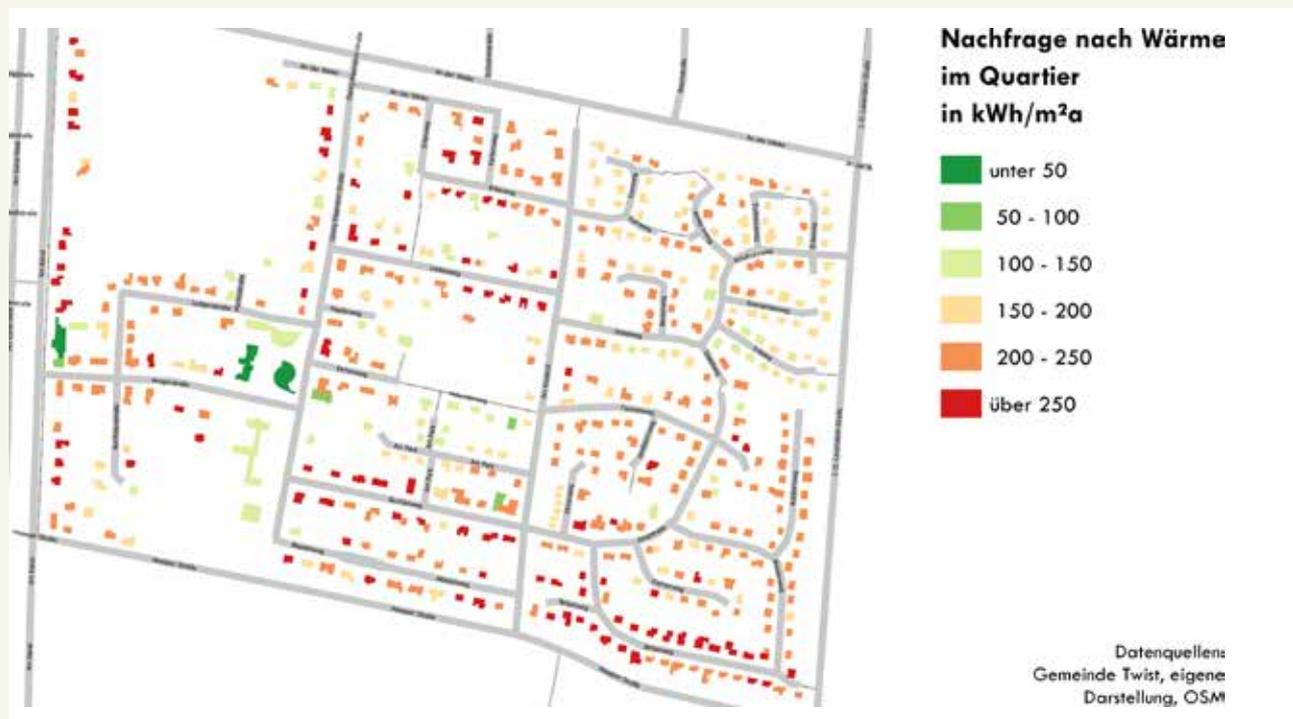
Abbildung 45: Wärmenachfrage der einzelnen Gebäude in kWh pro Quadratmeter und Jahr
