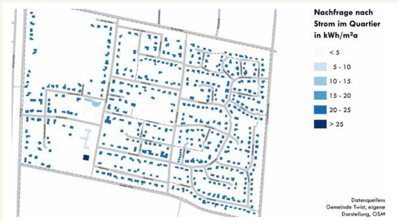
Abbildung 46: Nachfrage nach Strom der einzelnen Gebäude in kWh pro m<sup>2</sup> und Jahr
